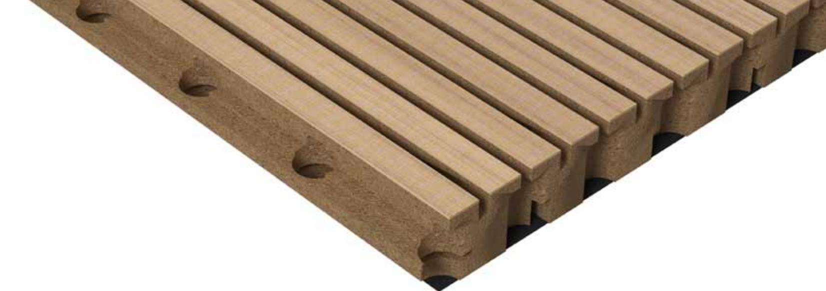
Pannello in MDF mod. Listen 40/2 con intercapdine riempita di pannelli in fibra di poliestere densità 40/m<sup>3</sup> spessore 20mm. Installazione in aderenza. Norma di riferimento: UNI EN ISO 354: 2003 UNI EN ISO 11654: 199
